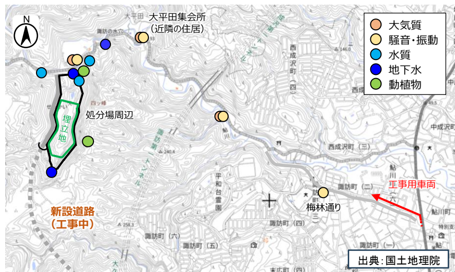
処分場建設工事中の環境モニタリング実施地点
