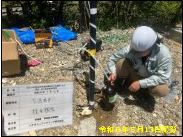
下流側モニタリング孔採水状況
