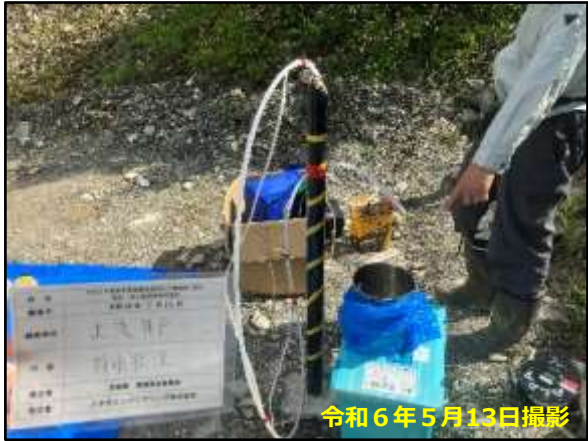
上流側モニタリング孔採水状況
