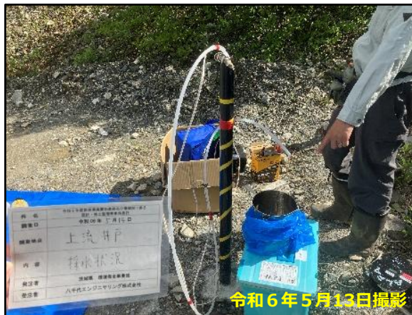
上流側モニタリング孔採水状況
