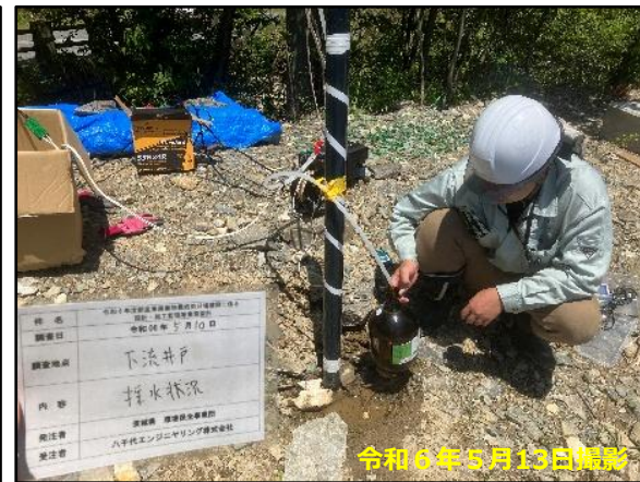
下流側モニタリング孔採水状況
