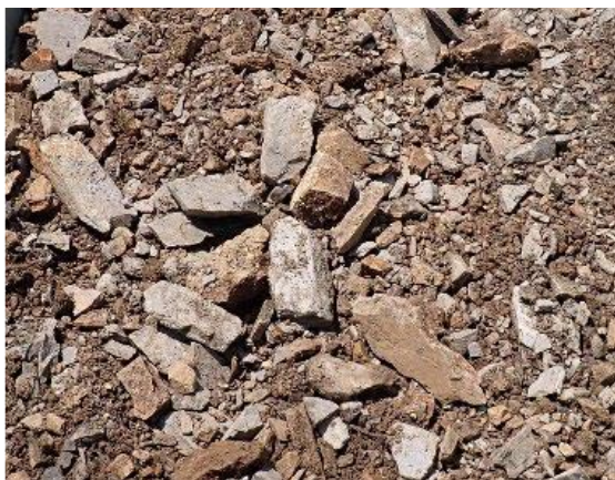
敷地造成に利用する周辺の堆積場の盛土材料（ズリ）
