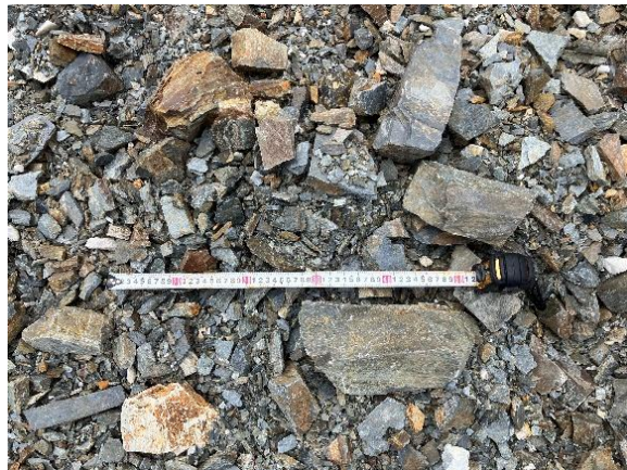
敷地造成に利用する周辺の堆積場の盛土材料（ズリ）
