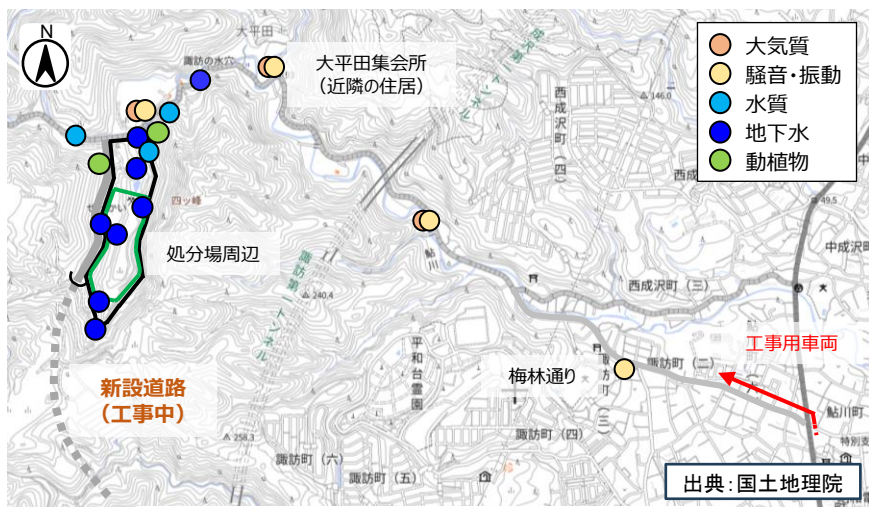
処分場建設工事中の環境モニタリング実施地点
